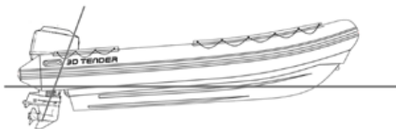
L'avant du bateau déjauge, trop de trim positif
