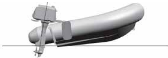
L'avant du bateau déjàuge, trop de trim positif
